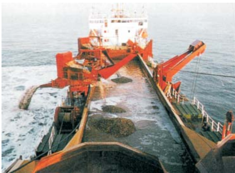
Figura 4. Cascalho sendo minerado através da draga (SUMMERHAYES, 1998).
