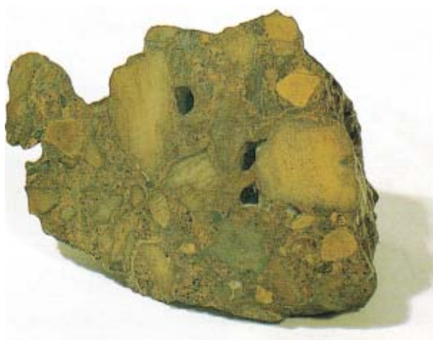
Figura 14. Carbonato fosfático com percentual de P_2O_5 ao redor de 15-18% dragado da plataforma continental do Marrocos (dimensão máxima 12 cm). É formado por um conglomerado de seixos de calcário fosfatizado imersos em uma matriz fosforítica onde estão presentes grãos tamanho areia verde-escuro a preto de glauconita (SUMMERHAYS, 1998).
