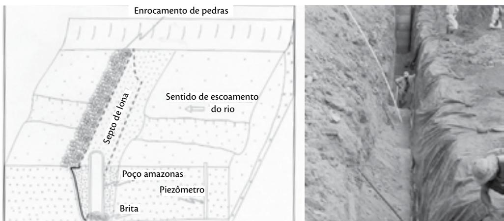
**Figura 1.** Desenho esquemático e detalhe da construção de uma barragem subterrânea no Modelo Costa e Melo
