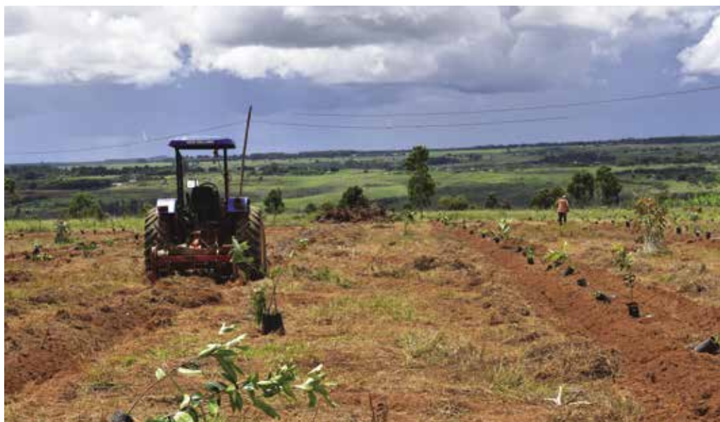
Foto 2. Enxada rotativa com subsolador sendo testada.
